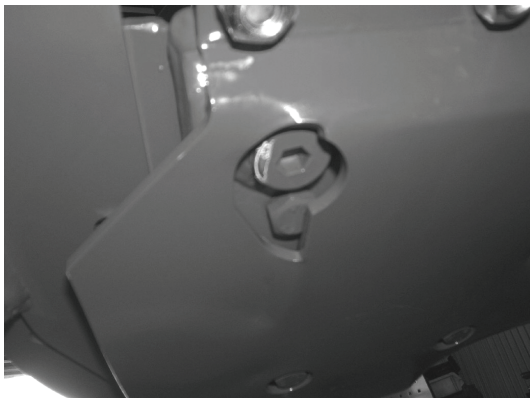
Abb. 11: Ablassöffnung unter dem Antriebsmähteller
