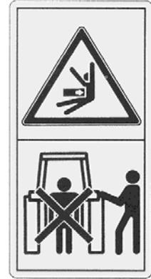
Bei Betätigung des Krafthebers außerhalb des Hubbereiches der Dreipunktaufhängung bleiben.
