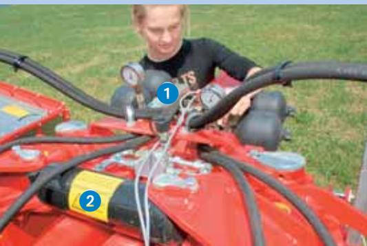
Hydrospeicher (1) sorgen für eine gut regulierbare Mähwerksentlastung. Der querliegende, hydraulisch vorgespannte Zylinder (2) sorgt für die Anfahrtsicherung.
