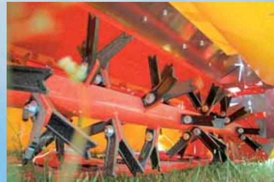
Die Kunststoff-V-Zinken sorgen für eine ordentliche Aufbereiterwirkung. Die Wurfschaube ist in fünf Stufen verstellbar, die Drehzahl über Scheibenwechsel zweifach.
