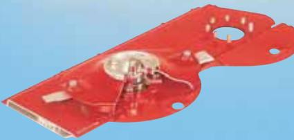
Der Monoblock-Balken ist leichtzügig. Ab 900 U/min an der Zapfwelle stimmt die Mähqualität. Keile mit Passfedern sorgen für die Überlastsicherung der Scheiben.
