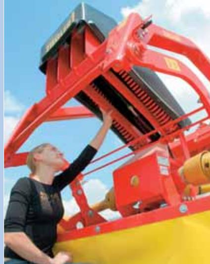
Die beiden Zugfedern reduzieren den Auflagedruck. Die Bodenanpassung in Fahrtrichtung ist gut, zur Seite durchschnittlich.
