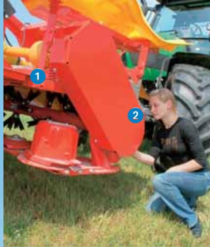
Der Zettermotor über vier Riemen ist kräftig. Die Vorspannung übernimmt eine Druckfeder (1). Durch die gekapselte Haube (2) ist die Kontrolle schlecht möglich.
