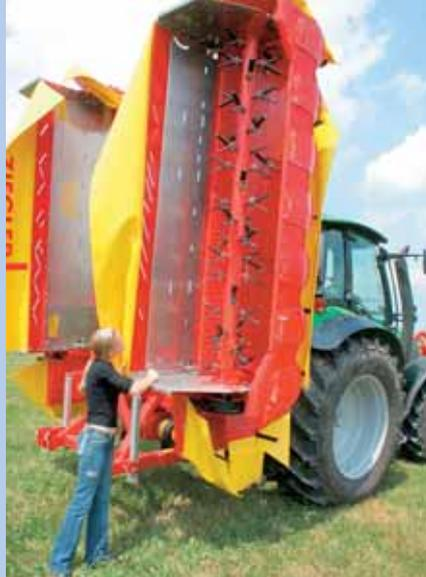
Ohne die eingesetzten Leitbleche legen die PD-Mäher je zwei Einzelschwaden ab. Die Ausführung aus Edelstahl ist gut. Die Lackqualität sollte besser sein.
