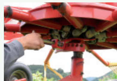
Die Kurvenbahnsteuerung lässt sich einfach in Rasten verstellen.
