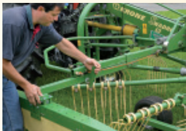
Das Schwadtuch lässt sich mit einer Klemmvorrichtung einfach verstellen.
