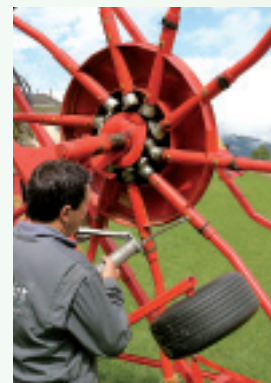
Die vorderen geraden Zinken sind um 1,5 cm kürzer als die hinteren gebogenen Zinken.
