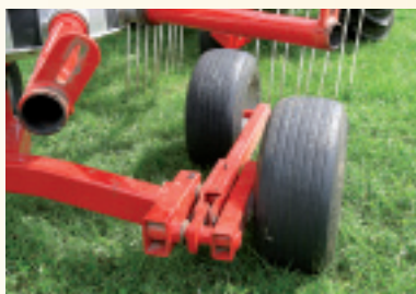
Diese patentierte Tandemachse läuft sehr nahe an den Zinken und arbeitet besonders wirkungsvoll.
