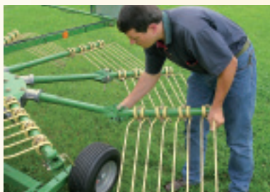
Die klappbaren Zinkenträger sparen Zeit bei der Umrüstung für den Straßentransport.
