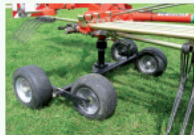
Leicht versetztes Tandemfahrwerk, Zinkenträger in Transportstellung.
