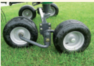
Die Tandemachse ist kurz gebaut und leicht versetzt. Zur Neigungsverstellung ist Werkzeug notwendig.
