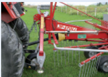
Spezielle Hangausrüstung: Laschen für tiefen Zuggpunkt und Rückhaltefedern im Anbauturm.
