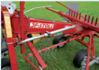
Seitliche Stützstreben zentrieren den Schwader beim Ausheben und verhindern ein Aufschaukeln bei schneller Fahrt.
