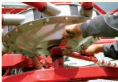
Durch das Lockern dieses Hebels lässt sich die Kurvenbahnsteuerung dem Futterbestand anpassen.
