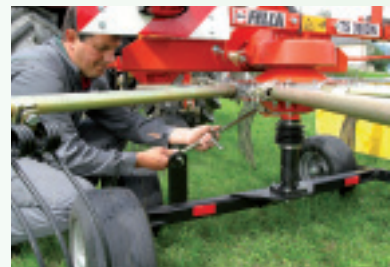
Einfache Anpassung der Kurvenbahnsteuerung an die Futterlänge.
