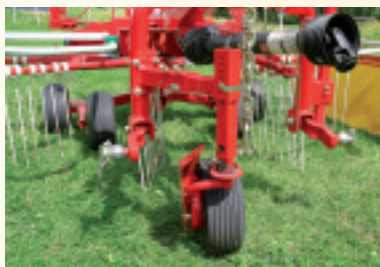
Dieses Stützrad lässt sich einfach in alle Richtungen verstellen und hat einen Wickelschutz.
