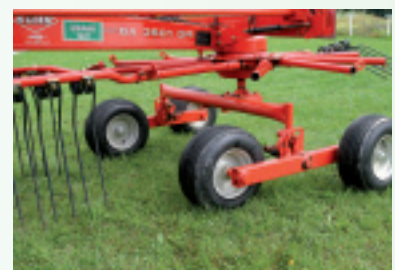
Arbeitshöhe und Seitenneigung lassen sich kombiniert an den Tandemachsen mit einem Bolzen verstellen.
