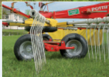
Die gekröpften Zinken sind direkt auf das Zinken­trägerrohr aufgeschoben und haben eine Stärke von 9 mm.
