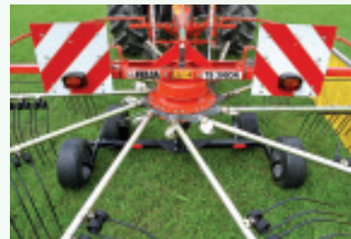
Schwadablage rechts. Beim Ausbau eines Zinkenträgers müssen alle Schrauben an der Glocke gelockert werden.
