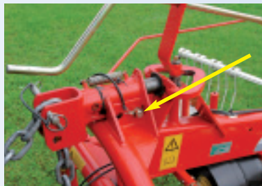
Für den Straßen­transport wird der Bolzen umgesteckt (siehe Pfeil), der den Kreisel fixiert.
