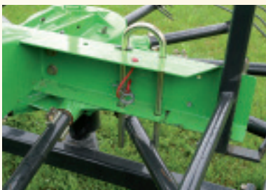
Die Verdrehsicherung des Kreisels ist stabil ausgeführt und lässt sich mit einem Federstecker fixieren.
