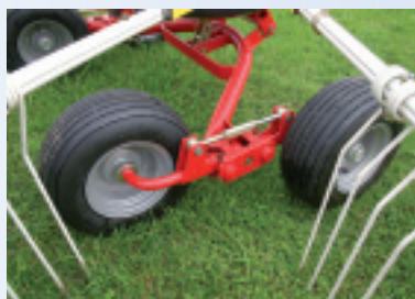
Tandemachse mit integrierter Seiten­neigungs­verstellung.
