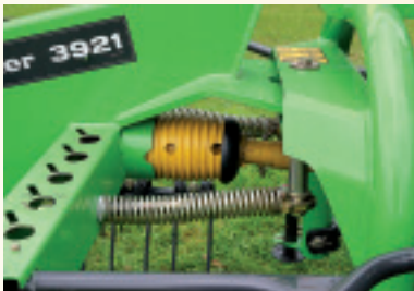
Dämpfstreben verhindern ein Aufschaukeln bei schnellen Fahrgeschwindigkeiten und stabilisieren den Schwader am Hang.
