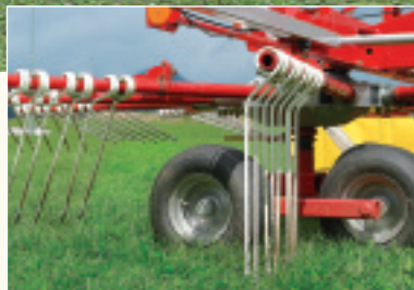
Die 9 mm starken Zinken sind auf dem runden Zinkenträger aufgeschoben und mit einer Klemmvorrichtung fixiert.
