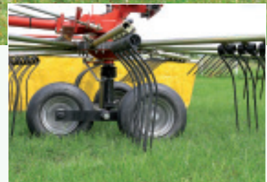
Die korbförmig gebogenen Zinken sind 9,5 mm stark und mit einer Halterung am Zinkenträger fixiert.
