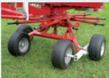
Leicht versetztes Tandemfahrwerk; keine Verdrehsicherung des Kreisels beim Transport.
