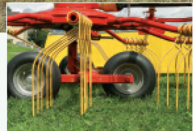
Die vorderen geraden Zinken sind um 1,5 cm kürzer als die hinteren gebogenen Zinken.
