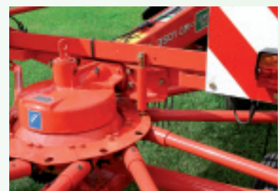
Passt der Bolzen nicht genau ins Loch, verbiegt sich das Blech.
