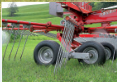
Die geraden Zinken sind mit einer Lasche am Zinkenträger montiert und haben eine Stärke von 9 mm.
