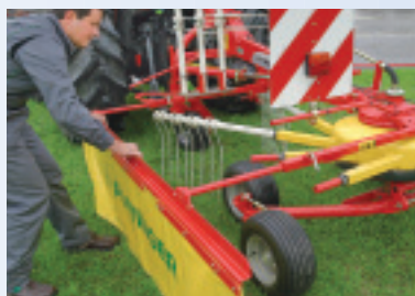
Das Schwad­ Tuch hat zwei Führungs­rohre. Einseitige Betätigung führt zu Verklemmen.
