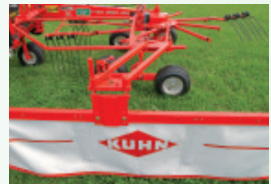
Die Verstellung des Schwadtuches erfolgt über ein Parallelogramm. Bei größerer Schwadbreite schwenkt das Tuch automatisch weiter nach hinten.
