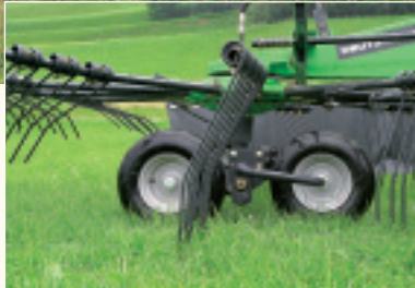
Die gekröpften pulverbeschichteten Zinken sind 9 mm stark.
