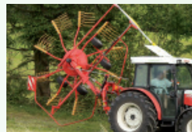
Schnelle Umstellung auf Straßen-transport vom Fahrersitz aus, aber Vorsicht bei niedrigen Durchfahrten.
