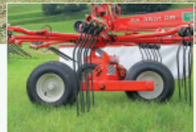
Die gebogenen Zinken haben eine Stärke von 9,5 mm und sind mit einer Lasche am Rohrträger montiert.
