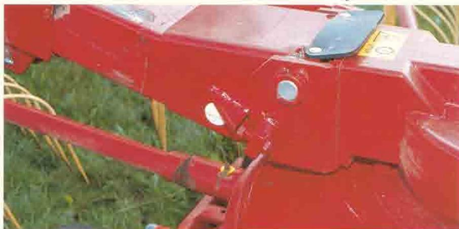
Sehr gut haben wir auch die Umstellung von Transport- in Arbeitsstellung bewertet. Der Knickrahmen wird lediglich per einfachwirkendem Steuerventil um 51 cm angehoben bzw. nach Entriegelung durch Seilzug „tiefergelegt“ und auf geht's, ohne vom Schlepper absteigen zu müssen. Das lästige Abnehmen und Aufstecken von Zinkenträgern gibt es hier nicht – ideal für Landwirte und Lohnunternehmer, die häufig Parzellen wechseln müssen.
