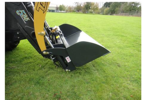
3. Schließen Sie den Rahmen des Teilers. Dadurch wird auch der Hydraulikzylinder des Foliengreifers geschlossen und der Raststift rastet auf der Rückseite der Schaufel ein
