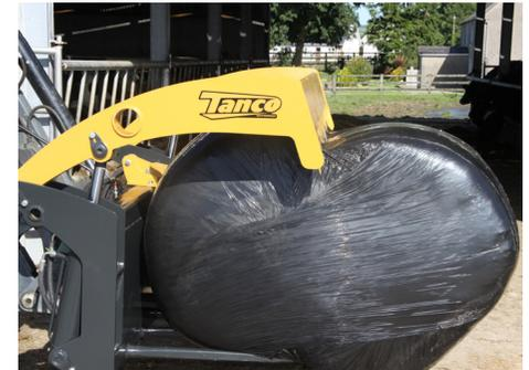
2. Schließen Sie den Rahmen mit dem hydraulischen Steuerhebel über dem Ballen, während sich gleichzeitig der Greifer schließt und die Kunststoffhülle festhält.
