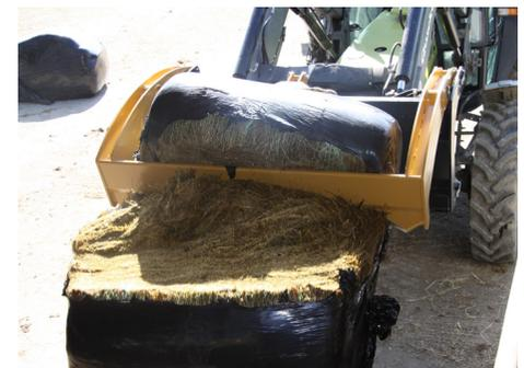
4. Öffnen Sie den Rundballenteiler fast vollständig mit den Steuerhebeln und heben Sie den Lader gleichzeitig an, um die Ballenhälften auf die Futterbahn oder in den Futterwagen zu entladen.
