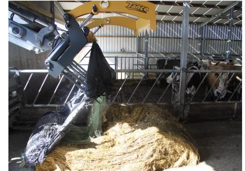
5. Heben Sie den Lader weiter an, um die noch immer von den Greiferklauen gehaltene Kunststoffhülle vom Ballen zu entfernen.
